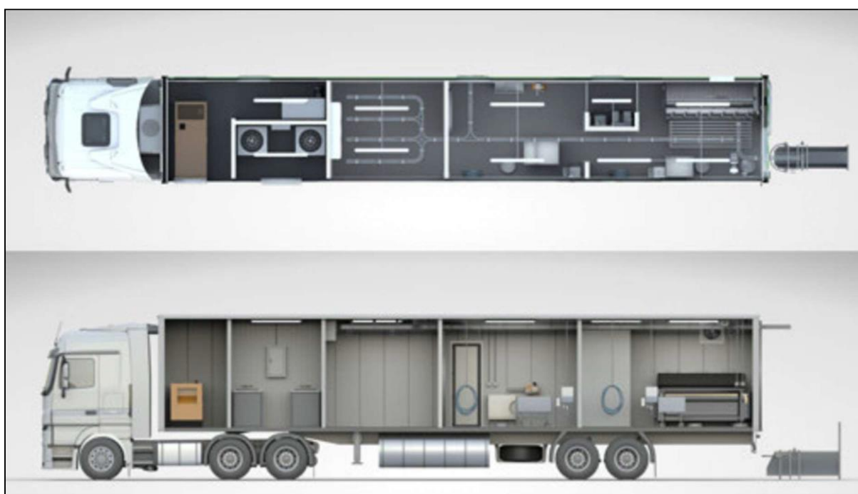
Illustration 12. Plan et coupe du "Projet d'abattoir mobile - INAC" Source. TecnoIncar - Technologie de l'industrie de la viande.
